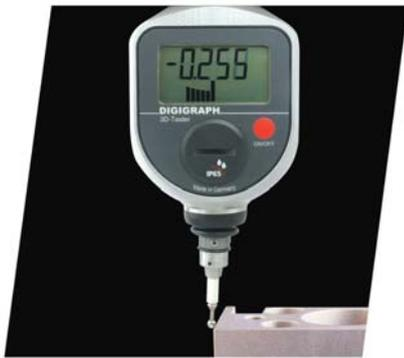
當探針開始與工件接觸後，主軸中心與工件邊緣的距離就可以讀出。
