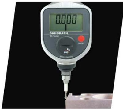
當指針回到零點時，主軸中心正好通過工件邊緣，即可設定工件座標。
